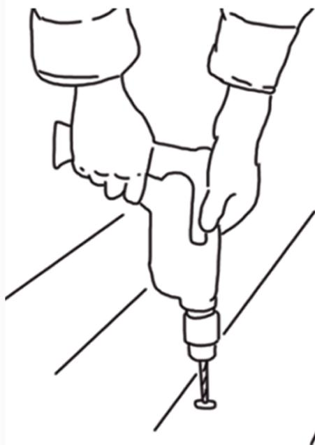
Perfore con taladro y la broca adecuada (nunca con golpes de clavo o punzón, pues creará fisuras en la lámina). El agujero debe tener 6mm de diámetro (1/4") y la longitud del tramo debería ser suficiente para sujetar una o dos láminas traslapadas más sus accesorios de sellamiento al polín de apoyo de los extremos.
