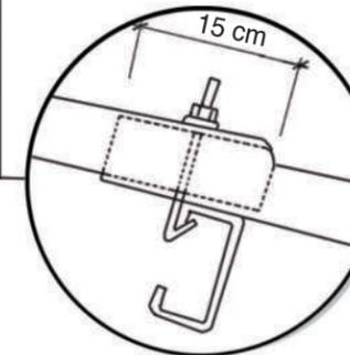
Las láminas Tejalita deben colocarse con un traslape transversal de 7 cm y los traslapes longitudinales deben ser de 15 cm.
