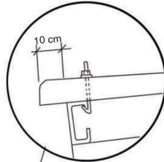
El voladizo en la longitud de la lámina desde su extremo inferior hasta la estructura, no debe exceder los 10 cm. OPCIONAL; a fin de dejar un alero suficiente sobre el canal, el distanciamiento entre el primer y segundo polín puede reducirse hasta 1.15 m. sin descuidar la medida del voladizo recomendado.
