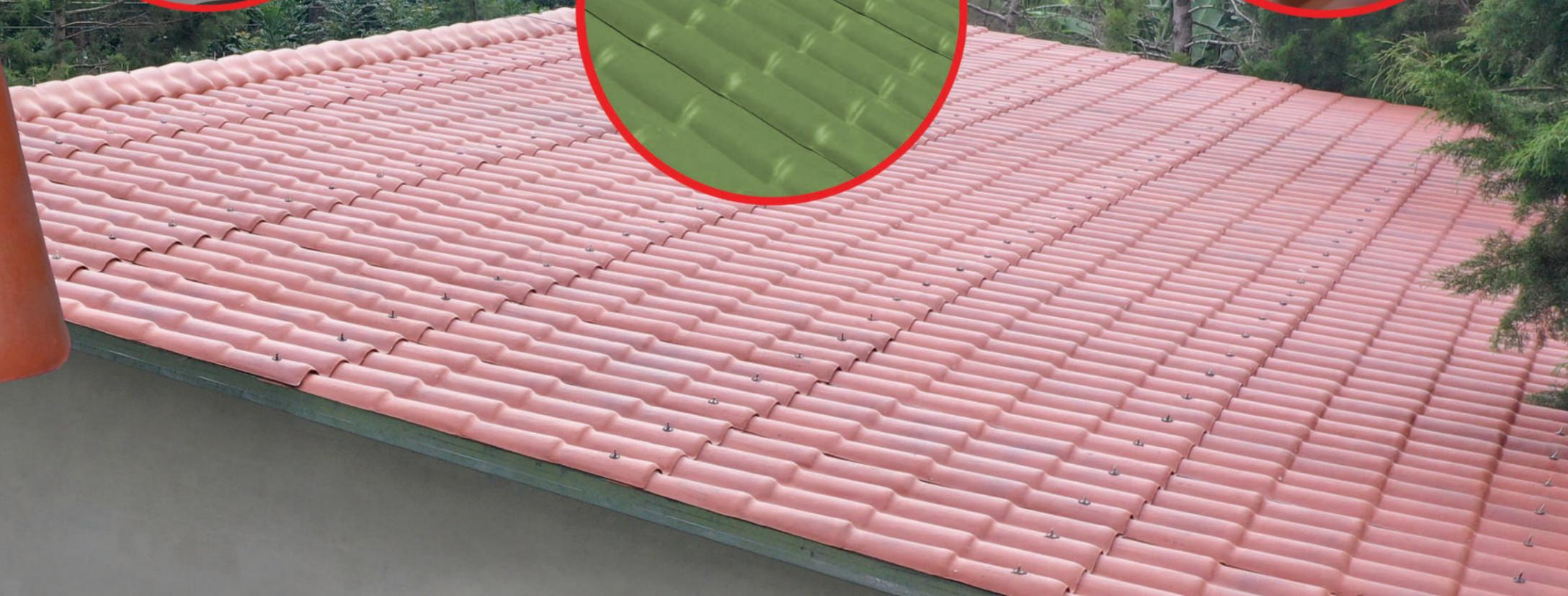
Inclinación mínima de **15%**, el traslape longitudinal debe ser de 15 cm. y el traslape transversal de 7 cm.
