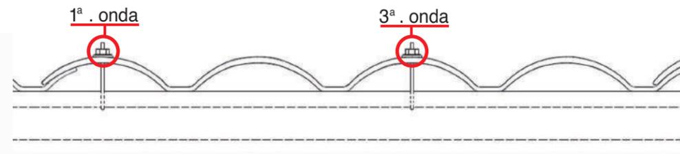
Coloque tramos en la 1ª y 3ª onda de cada lámina Tejalita y Nunca los coloque al centro cuando existe polín de apoyo
