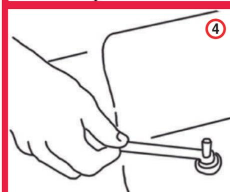
Para la sujeción del tramo se debe realizar manualmente el apriete de la tuerca hasta que se haga contacto con la arandela metálica, posteriormente con una llave se realiza una vuelta y media máxima (El exceso puede causar láminas fisuradas)
