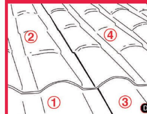
**D** Se coloca la cuarta lámina sobre las láminas despuntadas, evitando aprietes innecesarios en los tramos.
